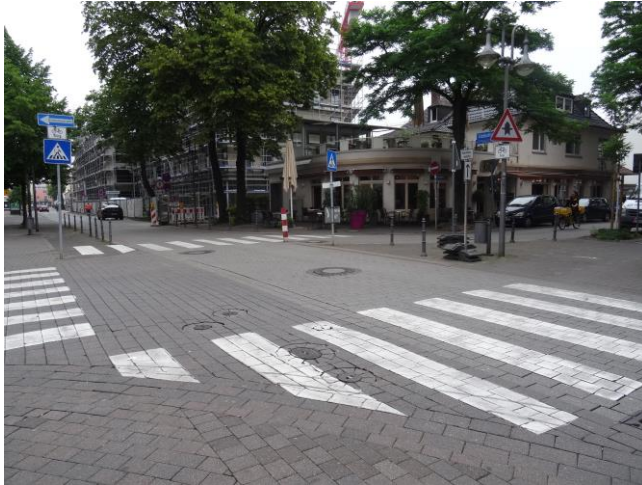
Bild 25: Knotenpunkt Strengerstraße/Eickhoffstraße mit baulicher Abtrennung für Rechtsabbieger aus Strengerstraße Ost
