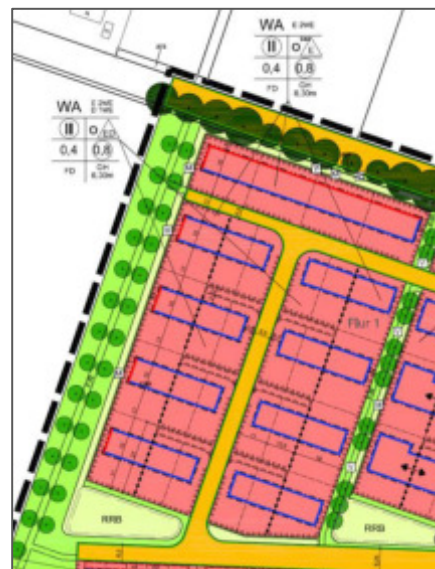
Karte 12: Auszug aus dem Bebauungsplan Nr. 108 B mit festgesetzten Baufeldern (blau) und Flächen für Regenrückhaltung und Versickerung (hellgrün)
